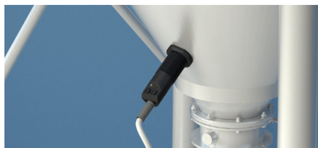
Сигнализация предельных уровней заполнения бункера кормом
