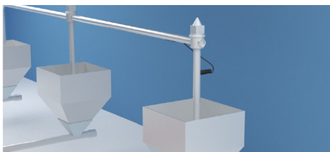
Контроль подачи корма в хопперы
